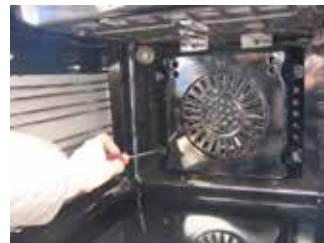
Зніміть кришку вентиляції відкрутивши гвинти
