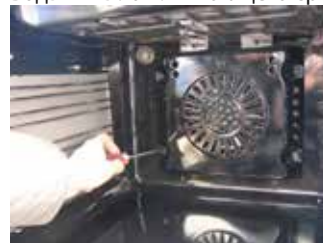
Снимите крышку вентиляции открутив винты
