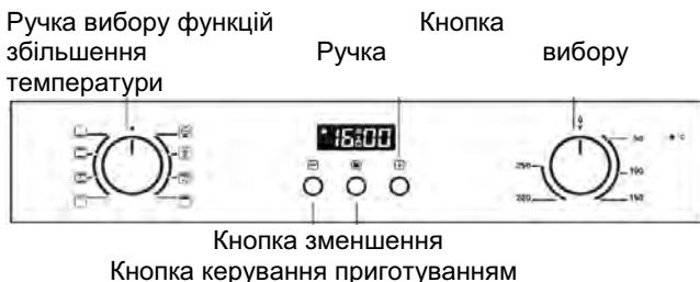
Духова шафа обладнана механічним керуванням з електронним програматором, 9-годинним таймером, автоматичним вимкненням та функціями автоматичного приготування. Під час первого підключення духовкої шафи до мережі електро живлення пролунає один звуковий сигнал, і духовка шафа переключиться в автономний режим. На екрані з'явиться надпис 12:30.
