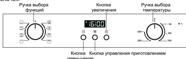
Духовой шкаф оборудован механическим управлением с электронным программатором, 9-часовым таймером, автовыключением и функциями автоприготовления. При первом подключении духового шкафа к электричеству раздастся однократный звуковой сигнал и духовой шкаф перейдет в автономный режим. На экране высветится 12:30.
